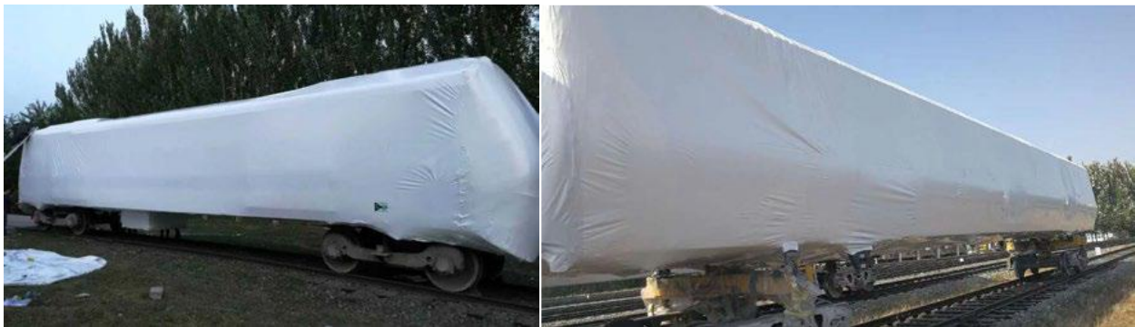
電車車両の屋外保管
