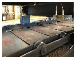
自動給油装置のピンポイント給油で 粉塵雰囲気でも使用可能
