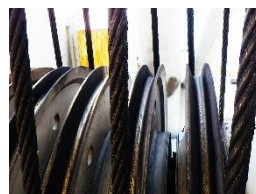
雨水のかかる屋外設備も、水置換効果で 潤滑可能
