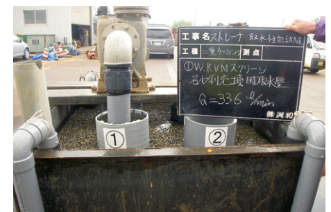
取水性能試験の様子
